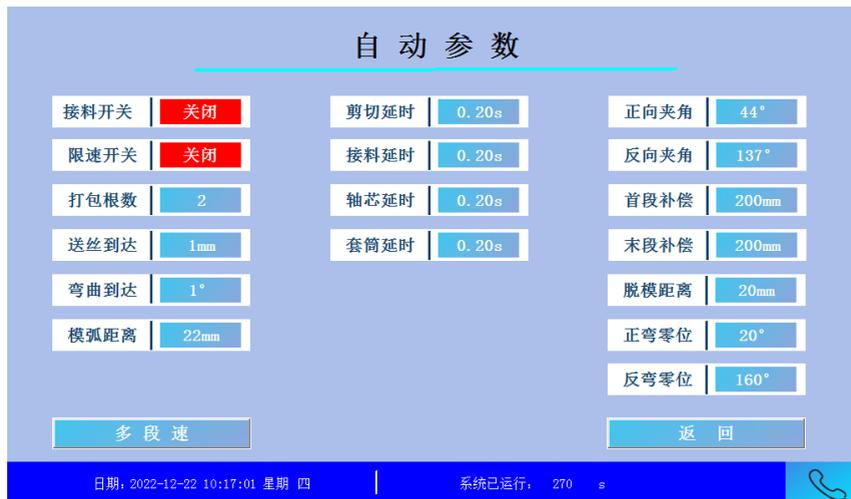
在 HMI 人机界面自动参数界面，点击【自动参数】文字，进入机械参数画面，弯曲辊周长为 360 度，弯曲减速比分子、弯曲减速比分母、弯曲编码器线数、弯头直径、轴芯直径和轴心距离按照实际数据设置。
