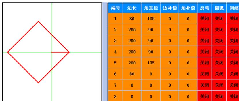
图 2-15 HMI 图形显示、图形数据参数界面
