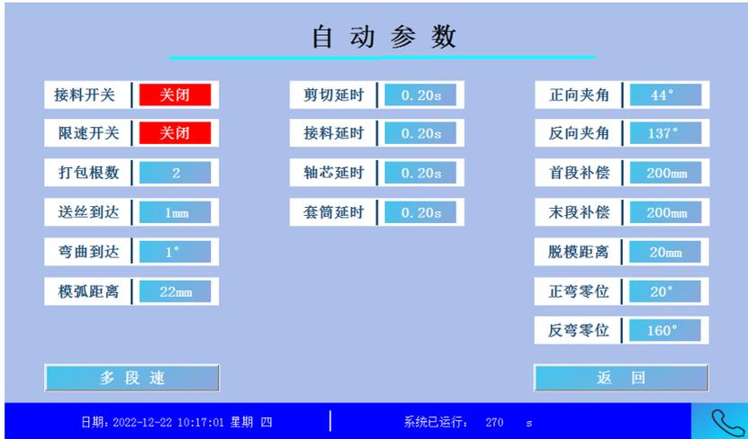
在 HMI 人机界面自动参数界面，点击『自动参数』文字，进入机械参数画面，送丝计数方式和速度输入方式要选择好，送丝计数方式为内闭环的话，需要正确输入内码盘送丝辊周长、送丝减速比分子、送丝减速比分母和内置编码器线数，送丝计数方式为外闭环的话，需要正确输入外码盘送丝辊周长和外置编码器线数。
