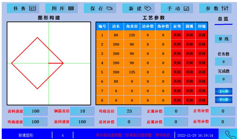
图 2-11 HMI 新建图形名称操作界面
